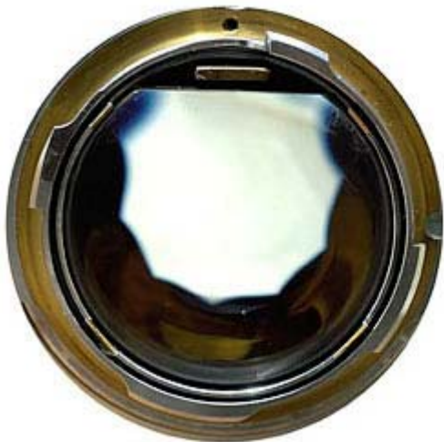
La famosa lente posteriore tagliata per lasciare spazio alla camma del telemetro ad azionamento rettilineo , come nei 135mm Leitz
