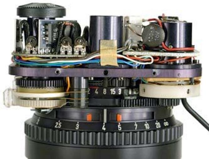
Altre viste dello Zeiss-AA privo di copertura: in evidenza le tre resistenze variabili a scorrimento (a sinistra), il pozzetto della cellula SPD (al centro) ed il motore elettrico di azionamento (a destra).
