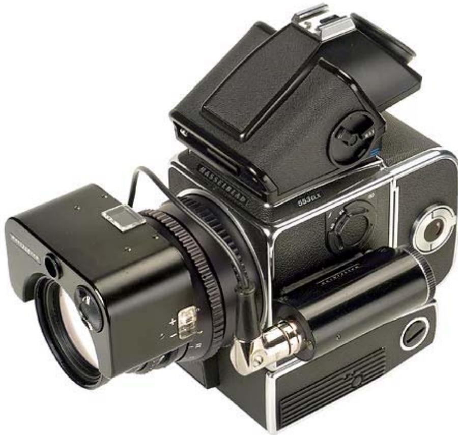
Lo Zeiss-AA 4/150 Sonnar montato sul corpo macchina ed alimentato col portabatterie ausiliario tipo 2 (codice 43133), dotato di una batteria tipo 2 DEAC 5/225 DKZ (codice 55026), il tutto montato sulla slitta porta-accessori del corpo macchina; questa alimentazione alternativa consentiva l'utilizzo del sistema su corpi macchina meccanici non motorizzati come 500C e 500 C/M.
