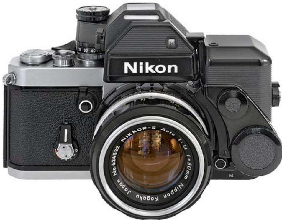
Abbinamento fascinoso: il Nikon Servo-EE DS-1 montato sull'appropriata Nikon F2S dotata di Photomic DP-2, pronto all'uso; notare la camma del DS-1 ingaggiata con l'omologo perno adibito allo svincolo del simulatore di diaframma del Photomic.
