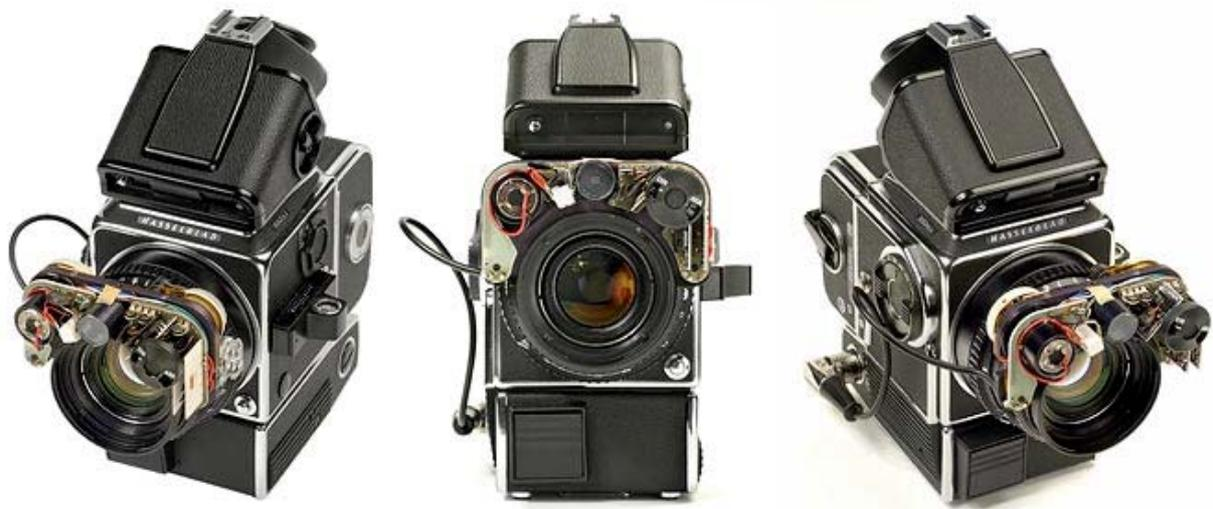
Tre vedute dello Zeiss-AA 3,5/100 Planar privo di esoscheletro e montato sul corpo macchina; si noti (nella veduta assiale) come una delle priorità del progetto fosse mantenere ingombri analoghi alla sagoma del corpo macchina, consentendone l'accesso agli angusti pozzetti appositamente predisposti sugli aeromobili per gli impieghi aero-fotogrammetrici.
