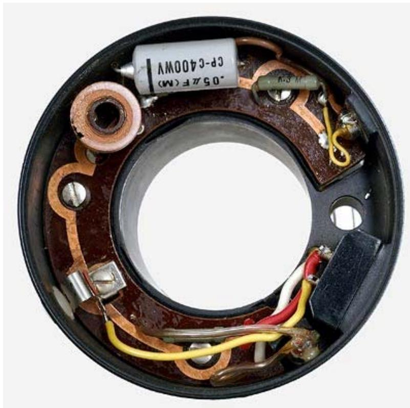
**Vista d'insieme dell'elettronica posta sul retro del modulo flash; anche in questo caso l'aspetto è piuttosto disordinato ed ingenuo; notare ad ore 8 la disarmante semplicità dell'interruttore che aziona le lampade pilota: una semplice linguetta che flettendosi attiva il contatto.**
