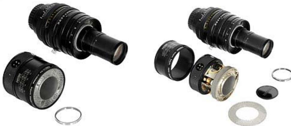
**Il Medical-Nikkor disassemblato: a sinistra si nota l'intero gruppo flash utilizzabile indipendentemente; a destra il canotto esterno rimosso rende visibili la parabola flash e le lampadine pilota per l'eventuale sostituzione; notare l'esiguo diametro del canotto porta-lenti, vincolo prioritario in sede di progetto per lasciare spazio ai componenti del lampeggiatore.**
