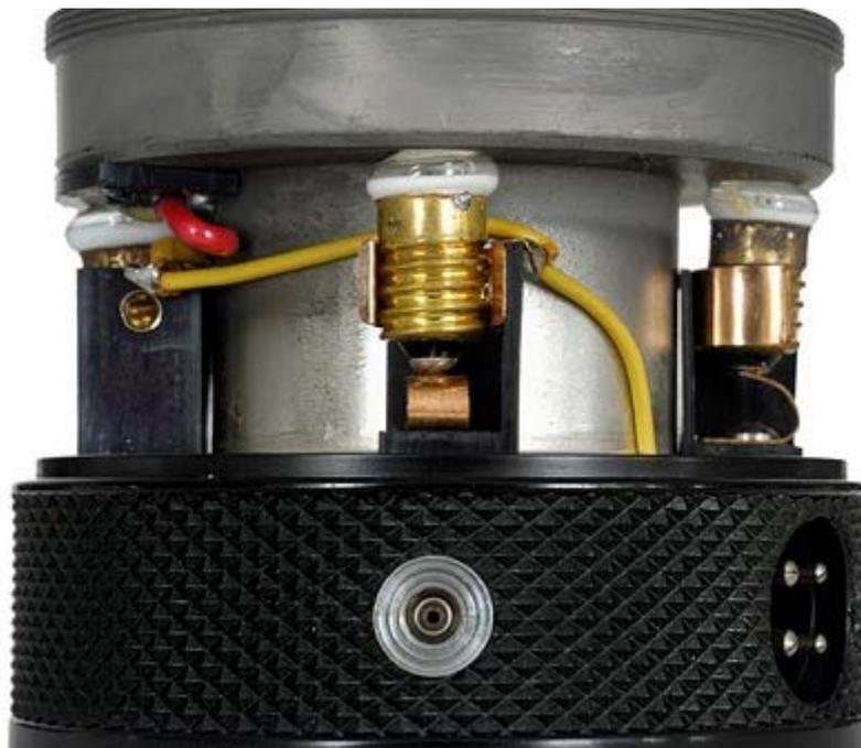
**Particolare del sistema di lampade pilota; notare l'aspetto approssimativo, quasi amatoriale della realizzazione.**
