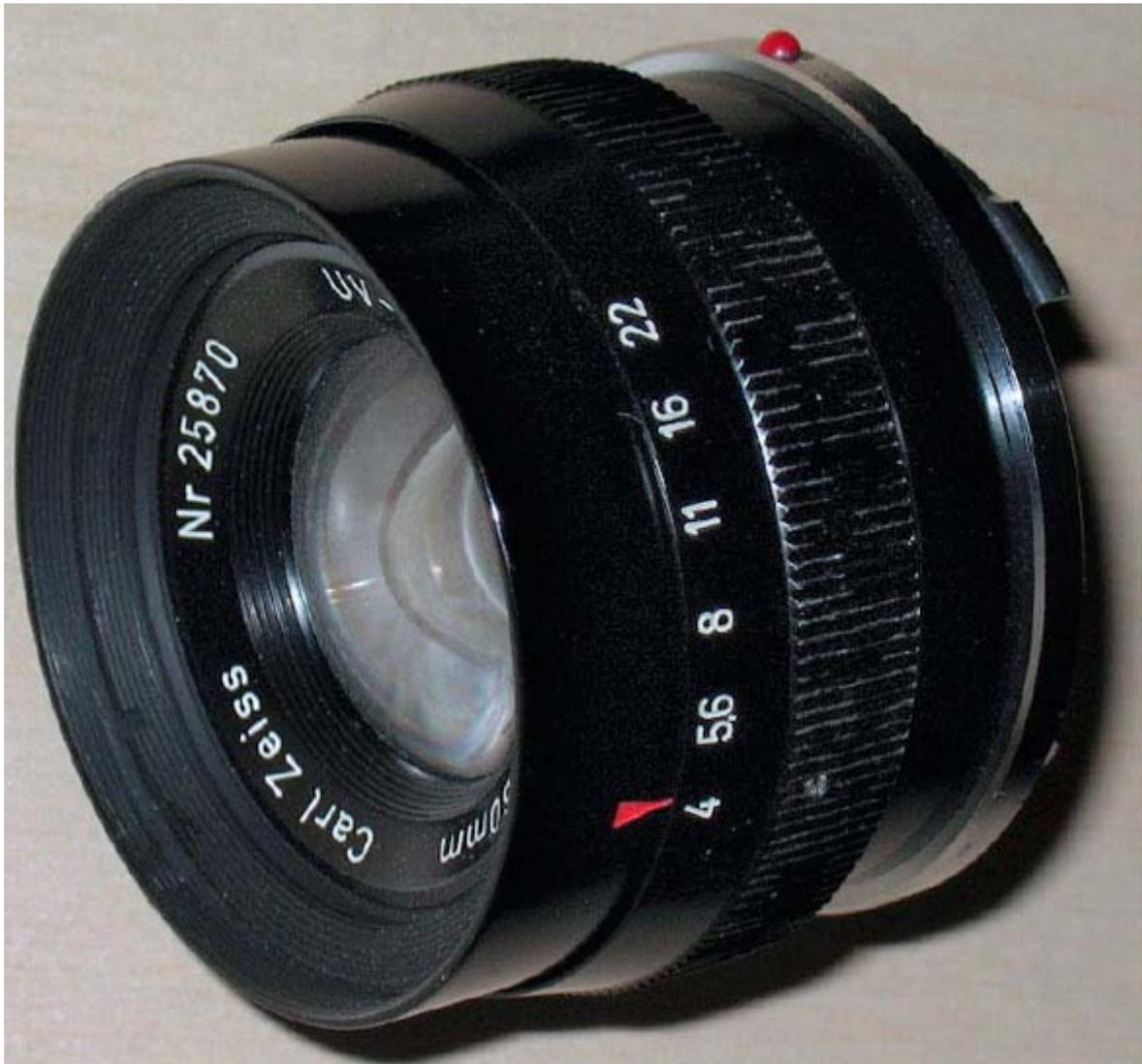
la montatura dell'UV-Planar 60mm f/4, completamente nera, è molto moderna per l'epoca; la scala dei diaframmi è graduata da f/4 ad f/22 e non è previsto un elicoide di messa a fuoco
