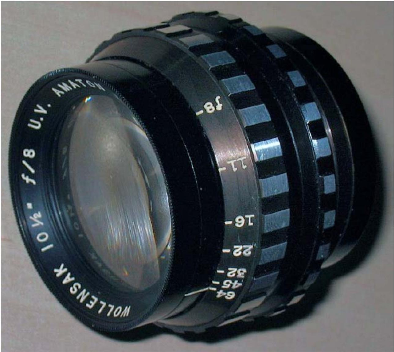
vista laterale del Wollensak UV Amaton 10 ½" f/8; si nota la montatura senza otturatore e la scala del diaframma graduata fino ad f/64
