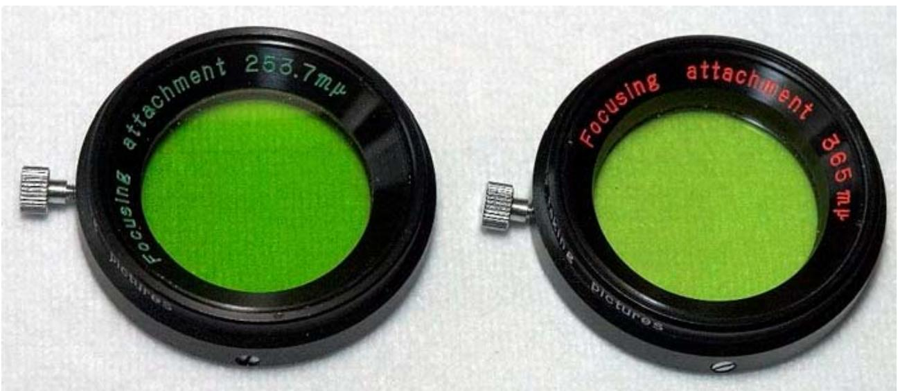
i due filtri taglia-banda destinati alla messa a fuoco; il taglio avviene rispettivamente al di sopra di 253,7nm e 365nm
