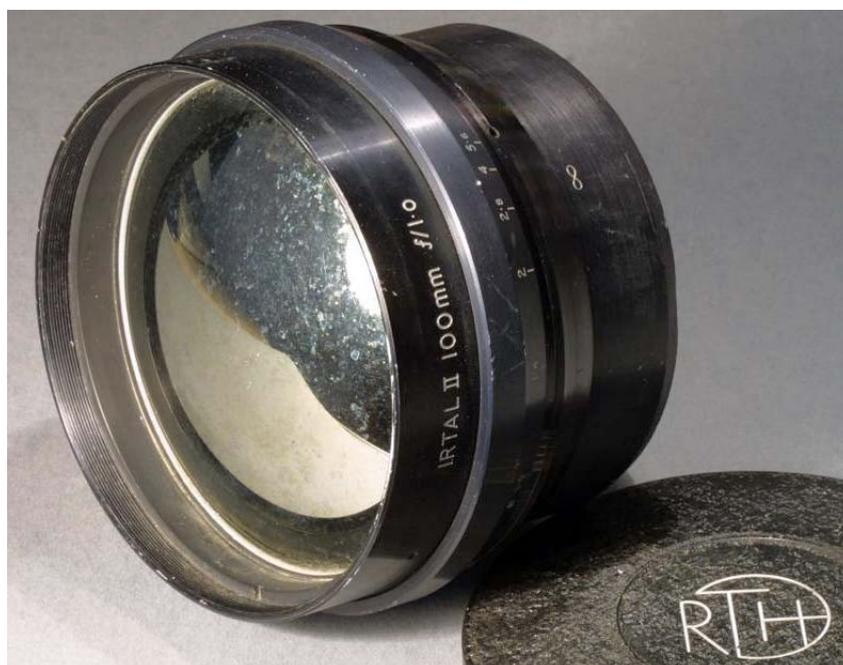
Rank Taylor Hobson IRTAL II 100mm f/1,0, esempio di obiettivo specifico per ripresa IR in campo spettrale di 2.000nm con lenti realizzate in Germanio, trasparenti a queste lunghezze d'onda estremamente elevate ma del tutto opache alla luce visibile.
