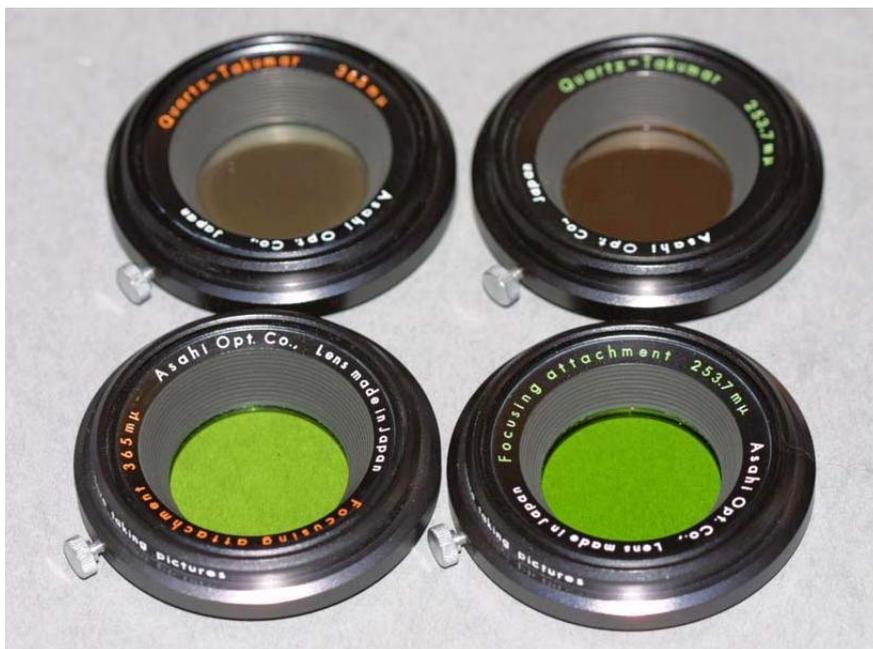
I filtri necessari per la ripresa UV sotto i 365nm e 253,7nm in duplice versione per l'inquadratura e la ripresa.
