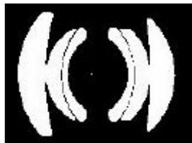
lo schema ottico dello Zeiss UV-Planar 60mm f/4, basato su un Gauss simmetrico
