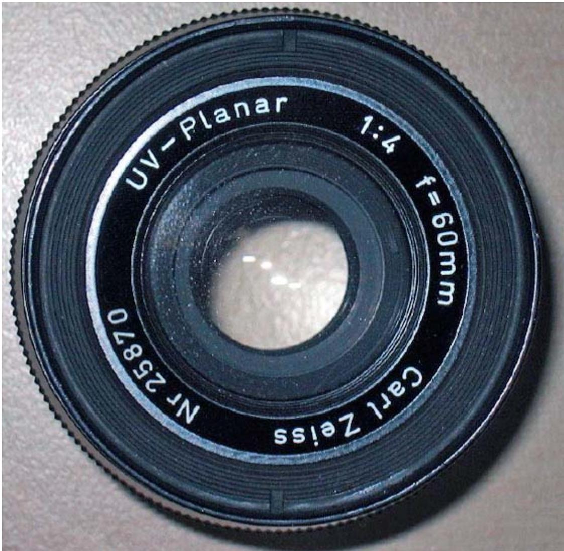
la vista frontale dello Zeiss UV-Planar 60mm f/4; l'assenza di lenti in quarzo è evidenziata dalle rigature sulla lente anteriore (il quarzo è estremamente resistente all'abrasione, 7 Mohs) mentre la matricola nell'ordine dei 2.580.xxx lo posiziona cronologicamente intorno al 1958
