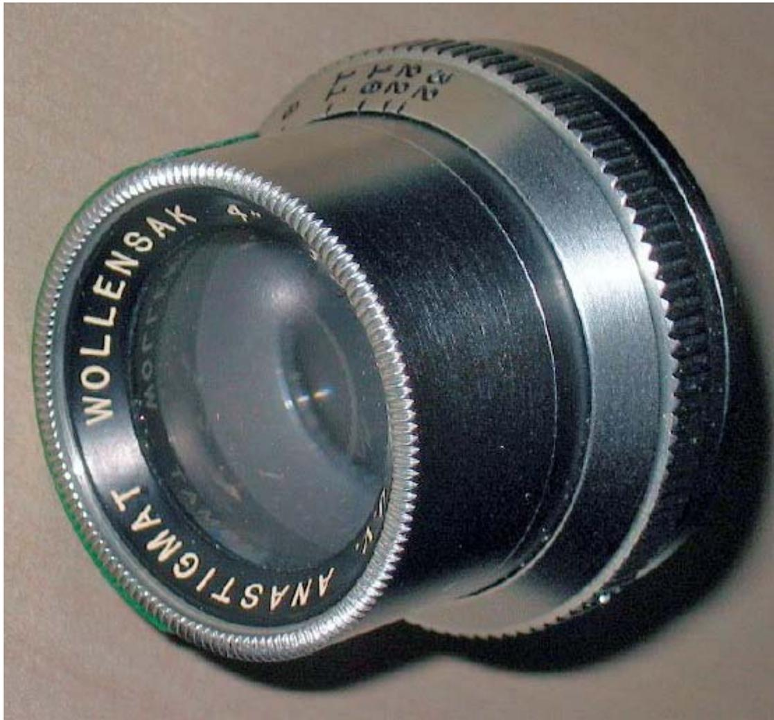
La montatura semplice, senza otturatore e con la scala dei diaframmi graduata fino ad  $f/32$
