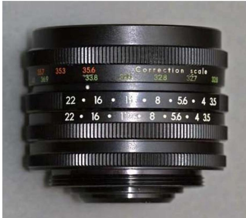
La scala di correzione della messa a fuoco relativa alle varie lunghezze d'onda UV impiegate.
