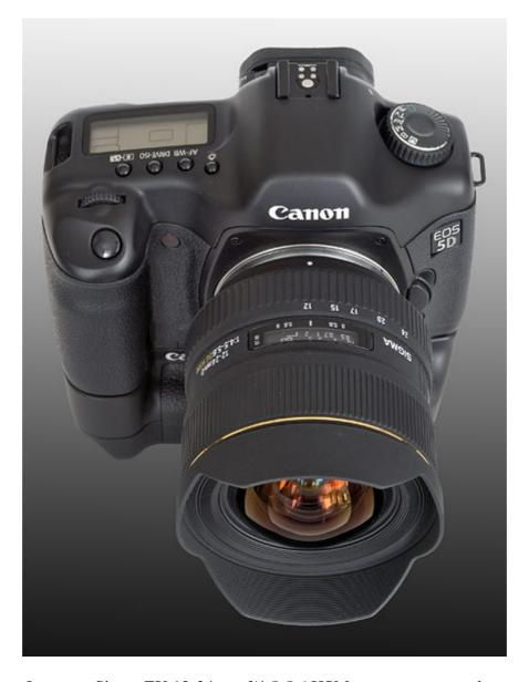
Lo zoom Sigma EX 12-24mm f/4,5-5,6 HSM a copertura completa adattato alla mia EOS 5 D con sensore 24x36mm: l'attacco tipo G rende impossibile il controllo del diaframma, che resta sempre a f/22
