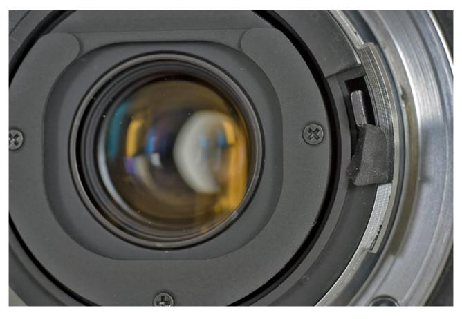
Il pezzo di gomma che mantiene sollevata la camma del diaframma nel Sigma 12-24mm in attacco Nikon G, impedendo che il diaframma lavori ad f/22 e prefissandolo ad un valore di circa f/8, adatto alla composizione ed alla ripresa
