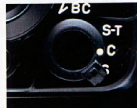
Selettore dei sistemi operativi impostato su "C", per riprese in serie successive.
