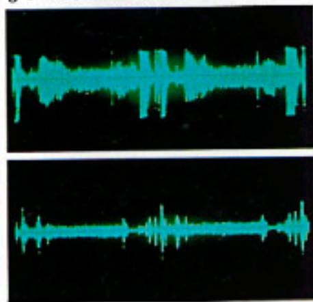
Oscillogrammi dei tests per la rumorosità della fotocamera. Sopra, il tracciato ondulatorio dovuto a fotocamere di altro tipo. Il tracciato estremamente piatto della Contax 137 MD Quartz, illustrato in basso, esemplifica l'elevato grado di silenziosità.
