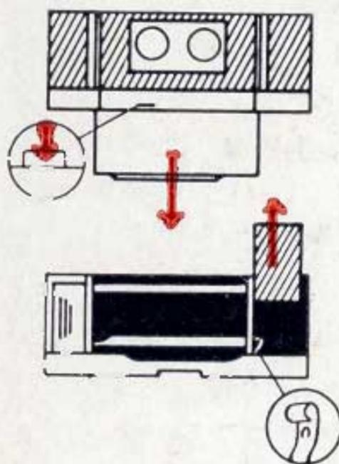
**2** Sortir entièrement le volet en appuyant simultanément sur le verrou (dans le cercle).
