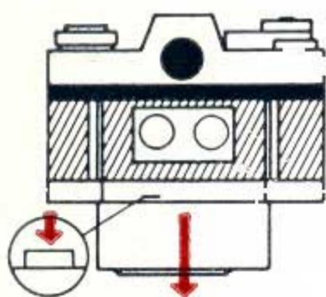
**5** Retirer entièrement le volet en appuyant simultanément sur le verrou (dans le cercle).
