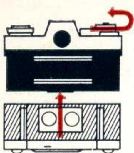
**3** Armer l'obturateur de l'appareil et mettre le dos-chargeur en place de la même façon que la paroi dorsale
