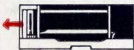
**4** Ouvrir le couvercle de la chambre de la bobine réceptrice en agissant latéralement sur les cannelures jusqu'à la butée.
